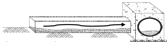
รูปที่ 6.4-8 ความลาดชัน (Slope) ของรางระบายน้ำเสียที่เหมาะสม
